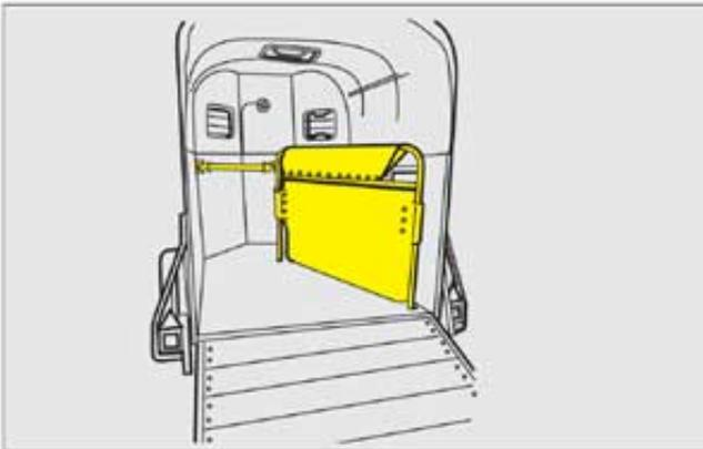
Besondere Vorsicht ist beim Öffnen der Heckklappe geboten, wenn ein einzelnes Pferd mit schräg zur Seite gestellter Trennwand transportiert wird und sich so am Fahrzeugheck keine Sicherungsstange befindet. Jetzt besteht Gefahr, dass das Tier mit der Hinterhand gegen die Heckklappe drückt.
