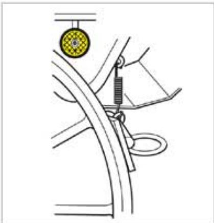
Alle Fahrzeuge müssen an der Rückseite mit zwei roten Rückstrahlern ausgerüstet sein. Diese dürfen nicht mehr als 400 mm (äußerster Punkt der leuchtenden Fläche) von der breitesten Stelle des Fahrzeugumrisses entfernt sowie höchstens 900 mm (höchster Punkt der leuchtenden Fläche) über der Fahrbahn in gleicher Höhe angebracht sein.
