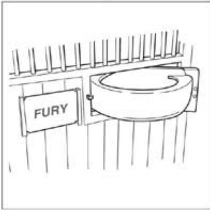
**Bilder 98 und 99:** Die Tür dieser Pferdebox ist mit einem schwenkbaren Futtertrog ausgerüstet. Der Trog kann bequem von der Stallgasse aus gefüllt werden, ohne dass der Pfleger die Box betreten muss. Ein Riegel verhindert, dass das Pferd spielerisch den Trog herausschwenken kann. Eine sinnvolle Einrichtung, die nicht nur Zeit sparen hilft, sondern auch das Risiko vermindert, von einem Pferd verletzt zu werden.
